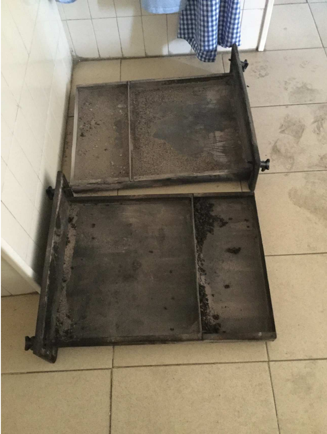
Imagen 1: Cajones deformados (frontal y juntas de aislamiento)
