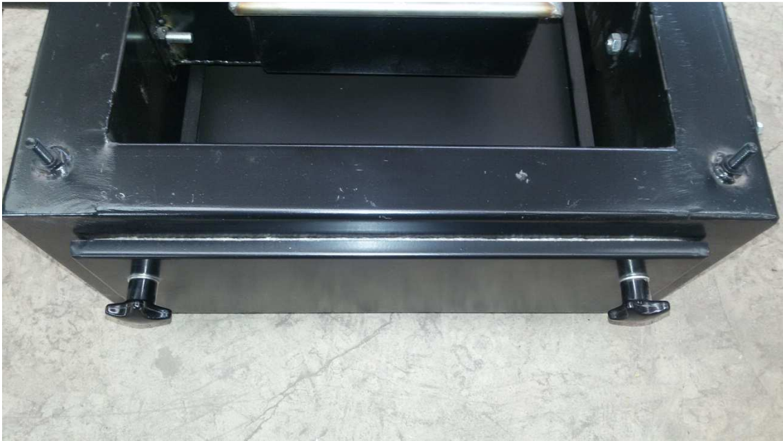
Imagen 5: Vista del frontal del cajón de ceniza cerrado.
