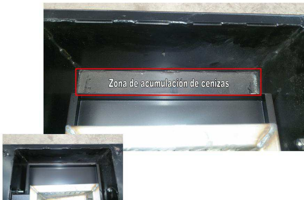
Imagen 4: Vista ampliada de la zona donde se produjo la compactación de ceniza (fondo del alojamiento del cajón de ceniza). (Foto de fábrica).
