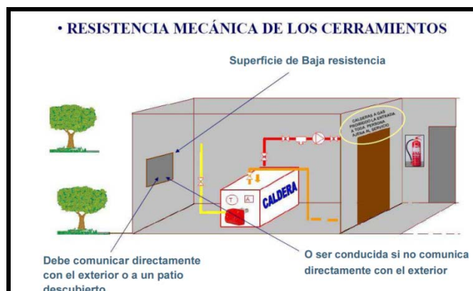
Figura 8. Resistencia mecánica de cerramientos.
